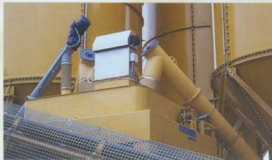
Weigh hopper loaded by silo Behälterwaage unter Silo Doseur alimenté par silo Dosatore alimentato da silo
