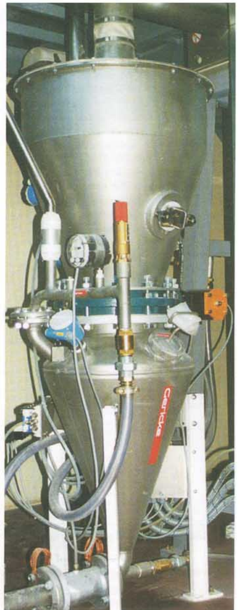
3: Pffropfenförderer für granuliertete Lebensmittel
