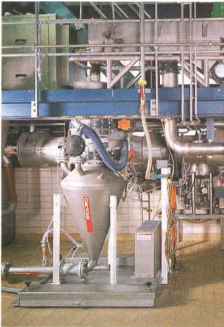
Abb. 4 Mobiler pneumatischer Pulse-Flow-Pfropfenförderer Typ PTA. Förderer auf Waage aufgebaut in einem Granulierungsprozeß der Pharmaindustrie.
